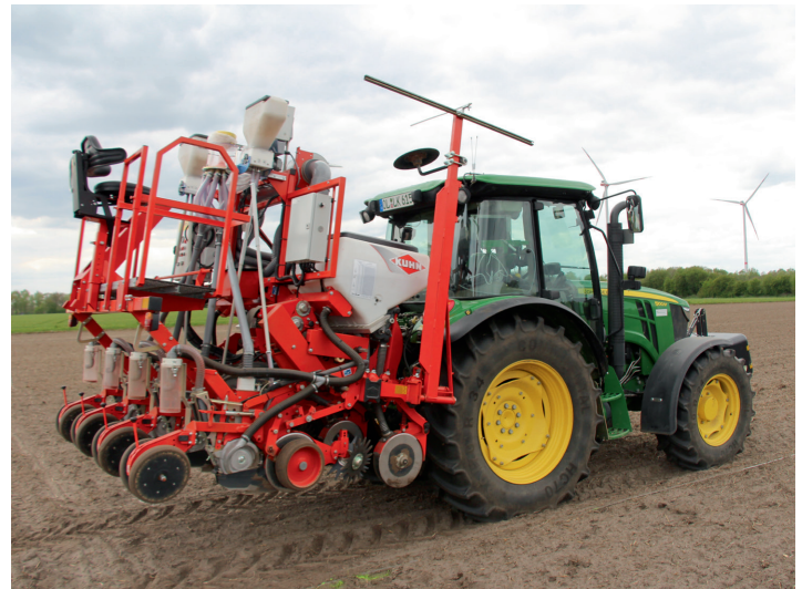
Versuchstechnik: Aussaat mit Mikrogranulatstreuer
